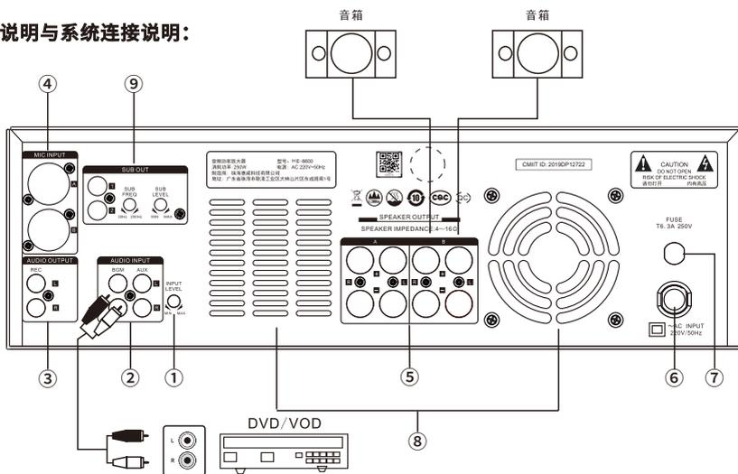
1. 输入信号幅度调节，如果音源幅度较大，请减小输入幅度，以避免因输入过大而失真。
